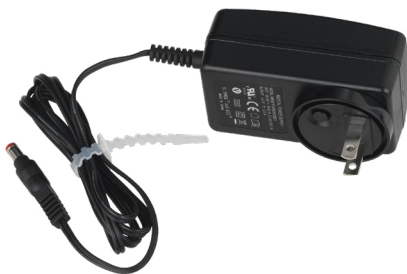
Figura 6: Fuente de alimentación (cargador)
